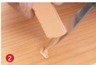
2 Verhit bijvoorbeeld een mesje met isolerend heft en smelt daarmee de was. Druppel de ondiepte rijkelijk vol.
