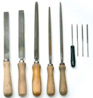
Een collectie vijlen, van links naar rechts: blokmodel, halfronde, drie- en vierkante, ronde en wat sleutel-vijltjes.
