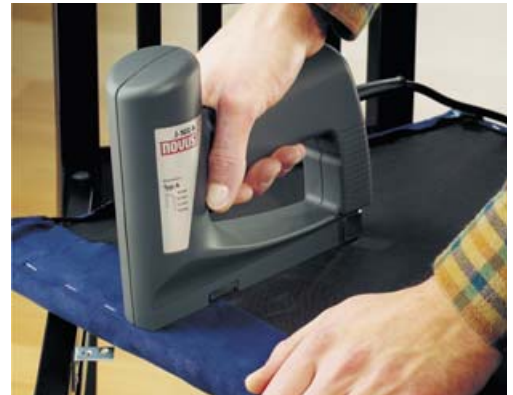
Een elektrische nietmachine kan steviger nieten aan en is makkelijker te gebruiken dan een handnietmachine. Op den duur is die laatste ook vermoeiender. Door de nieten dicht bij elkaar te zetten, wordt de spanning op bijvoorbeeld bekledingsstof gelijkmatiger verdeeld.
