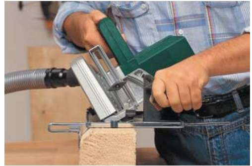
De cirkelzaag kan onder een hoek zagen door hem ten opzichte van de voetplaat te kantelen. Met een langsgleider kan de machine in een kaarsrechte lijn zagen.
