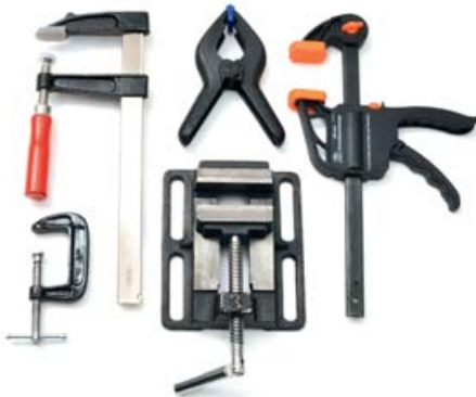
Diverse klemgereedschappen. Meestal zijn er twee of meer klemmen nodig om iets goed vast te zetten, behalve bij de bankschroef.
