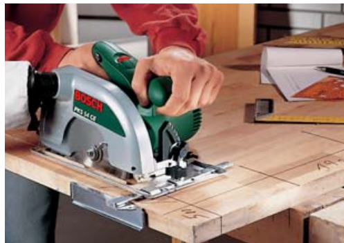
Lange, rechte zaagsneden zijn het snelst en best te maken met de cirkelzaag.
