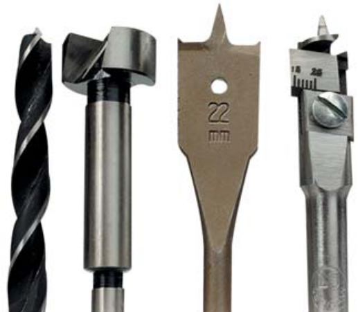
Van links naar rechts: houtspiraalboor, forstnerboor, speedboor en verstelbare speedboor.
