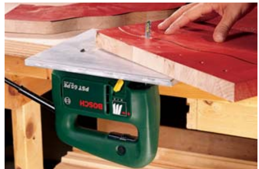
Sommige decoupeerzagen kunnen stationair worden gebruikt met een zaagtafel, waardoor beide handen vrij zijn voor het werkstuk.
