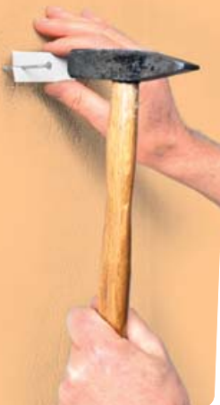
Buig de punt van de spijker met een combinatie tang haaks om. Drijf de omgezette punt in het hout.
