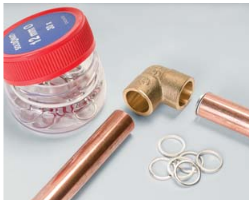
Steek beide buizen met een soldeerring in de fitting (hier een kniestuk), om ze tegelijk te solderen. Druk de buis met ring goed aan en zorg dat de buizen goed haaks ten opzichte van elkaar zitten.
