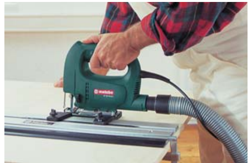
Ook met de decoupeerzaag lukt recht zagen aardig met een langsgleider.
