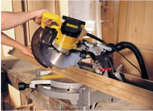
De kap- en verstekzaagmachine maakt exact onder hoeken zagen mogelijk.
