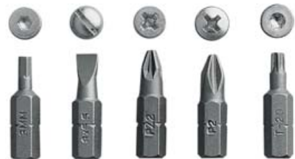
De bitjes van links naar rechts: inbus, gleufkop, Pozidrivkruiskop, Phillipskruiskop en Torxkop.
